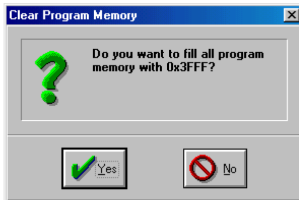
Figura 68.- Cuadro de selección de limpiar todas las posiciones de memoria de programa poniéndola toda a unos.
